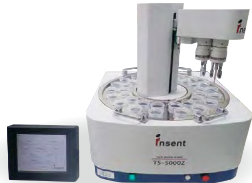
味覚センサー： 人間の舌と同じメカニズムを持ち、様々な食品、医薬品などの味を数値化できる装置。
